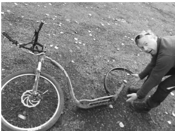
Å teste utstyret FØR tur er viktig. Quick-releasen røk og bakhjulet løsnet. Bildet er fra testturen helgen før
